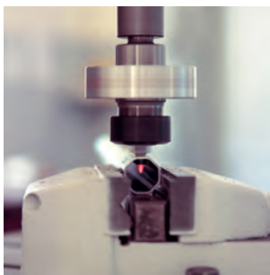
Fließbohren / Flow drilling
